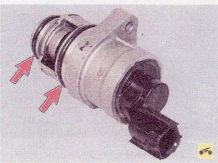
Обратите внимание на то, что герметичность соединения обеспечивается двумя резиновыми кольцевыми уплотнителями. Замените уплотнители, если они повреждены.
