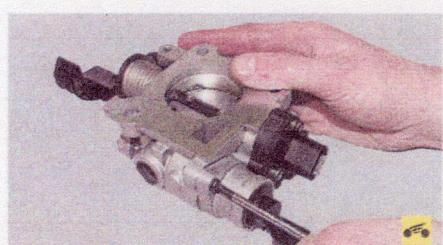
4. Выверните винт крепления регулятора к дроссельному узлу...
