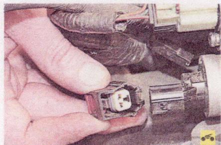
3. ...отсоедините колодку жгута проводов от регулятора холостого хода.
